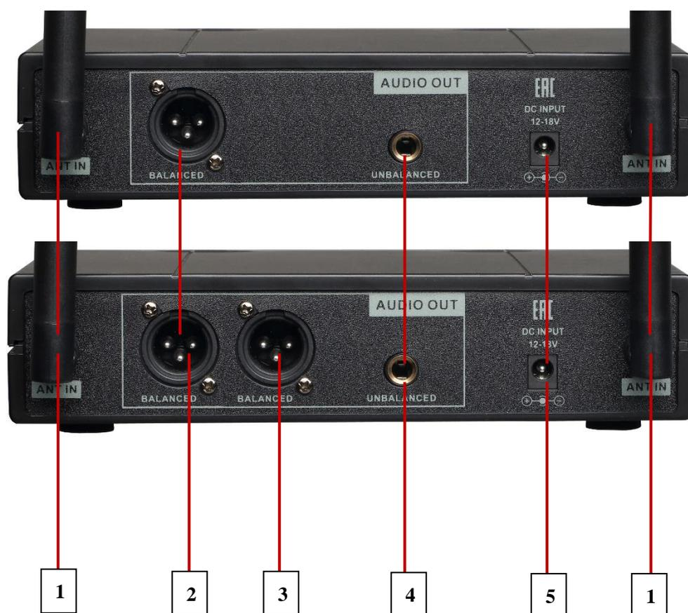
1. Разъём подключения приёмной антенны
